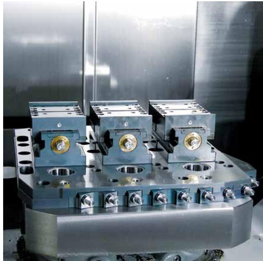
Ein System für alle Ihre Vorrichtungen und Spannmittel. Durchgängig mit geringem Stichmass finden Sie für jedes Ihrer Spannvoraussetzungen Lösungen. Beispiel Nullpunktspannsystem speed.change 30 in Kombination mit hemo optima.
