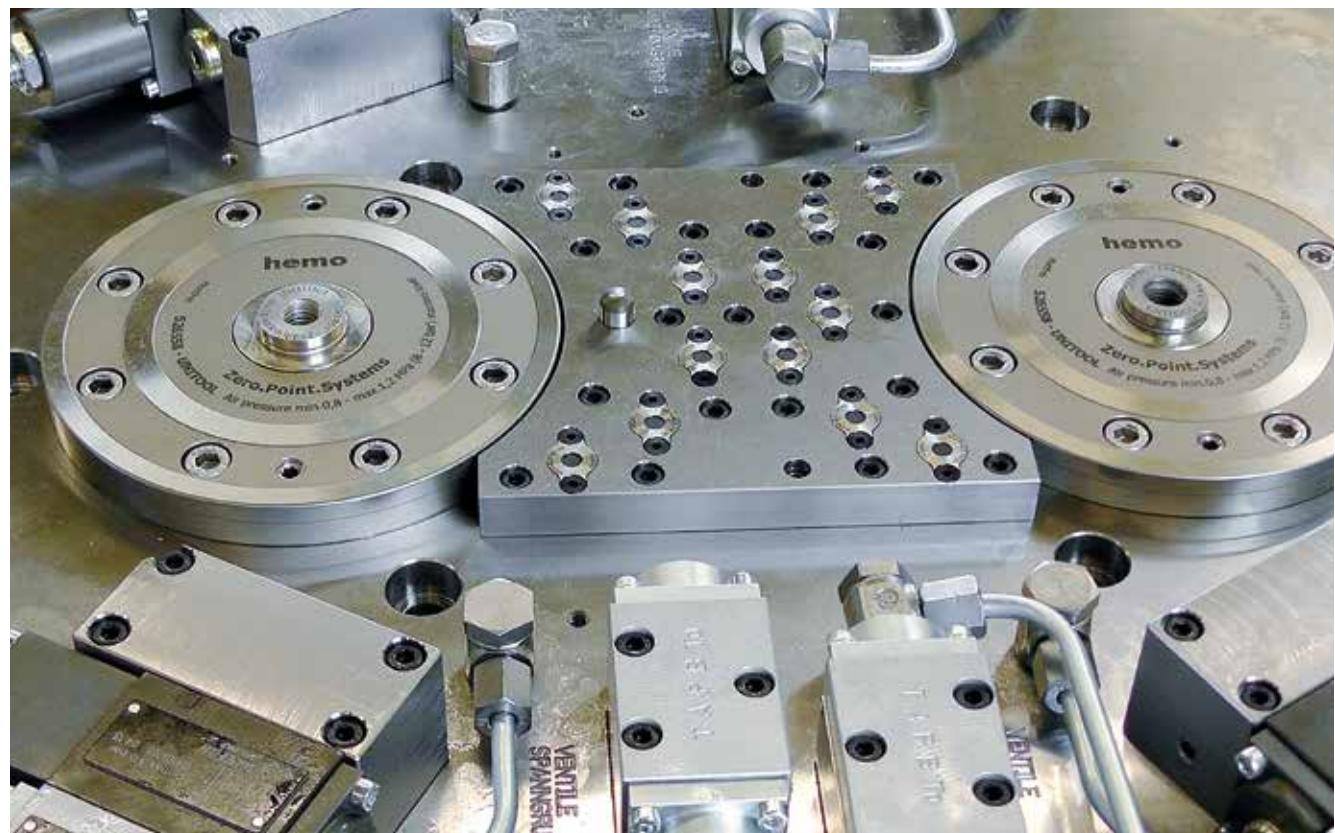
Hydraulische Spannvorrichtung mit integriertem Nullpunktspannsystem.
