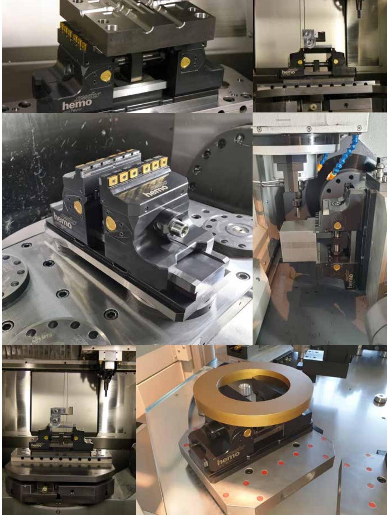
5-Achs- & Zentrunspanner | Étau à serrage centré et 5 axes | Centering vice & 5 axes
