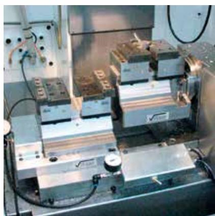
**Pneumatische Spannvorrichtung in Verbindung mit einer 4. Achse.**
