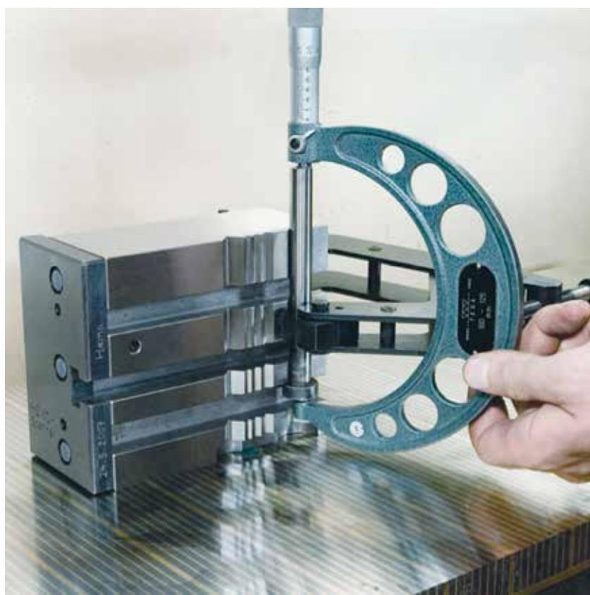
**Rückseitig integriertes Spannprisma zur Aufnahme von Rundmaterial.**
