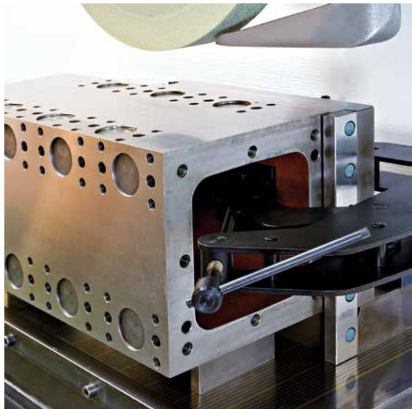
hemo Mehrfach-Prisma mit liegendem Unterbau als Stempelauflage.
