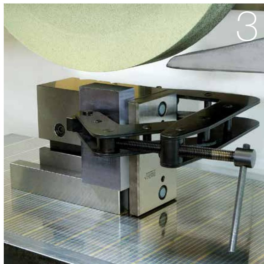
Geschliffene Werkstück-Längsseite an der Anschlagleiste anschlagen, spannen und schleifen des zweiten Winkels.
