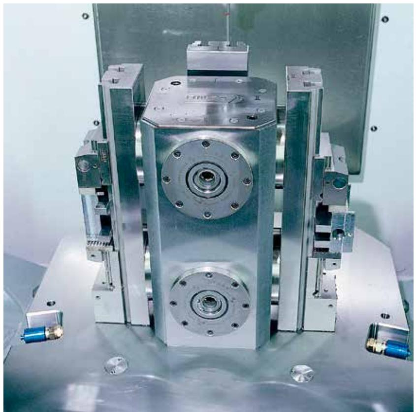
Spannung von grösseren Werkstücken mit 2 parallel angeordneten und palettierten hemo MFS Systemen.
