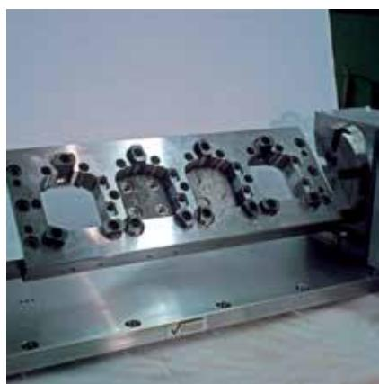
Mechanische Vorrichtung als Spannbrücke.
